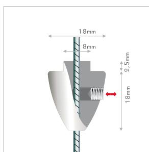
**IT** supporto per ripiani su cavi, sistema a brugola. per fissare su cavi ripiani e mensole in modo facile e sicuro. infilare il cavo e fissarlo con la brugola. che sia in negozio, in ufficio o a casa: spessore del cavo: max. Ø1,8mm.
