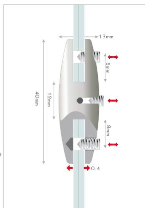
**IT** pinza laterale doppia. morsetto laterale per il fissaggio su cavi di due pannelli affiancati. il fissaggio al pannello e al cavo avviene tramite le brugole. spessore del cavo: max. Ø1,8mm.
