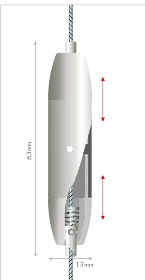
**T** tensionatore per cavi con sistema autobloccante. per un'ottima tensione di cavi molto lunghi. inserire l'estremità del cavo in link, dove il sistema autobloccante lo tratterrà, e regolare la tensione avvitandolo. il forellino centrale garantisce un avvitamento più stretto. spessore del cavo: max Ø1,8mm.
