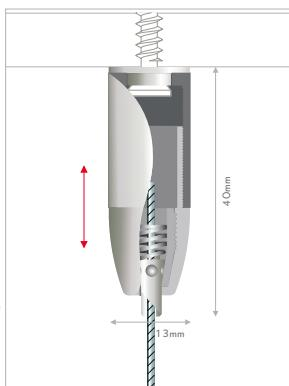
**IT** tirante per cavi, sistema in tensione autobloccante. montare il tirante ed inserire il cavo: il sistema di autobloccaggio lo trattiene automaticamente. regolare la tensione del cavo avvitando il tirante. spessore del cavo: max. Ø1,8mm.
