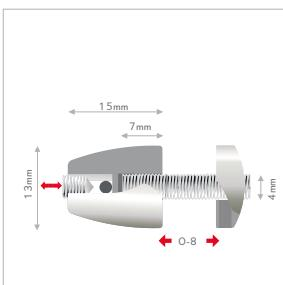
**I** pinza per cavo regolabile, montaggio frontale. fissare la pinza al cavo di acciaio e al pannello tramite le brugole, completare il fissaggio del pannello con la testina di front. ideale non solo per pannelli ma anche per cubi e/o ripiani. spessore del cavo: max Ø1,8mm.
