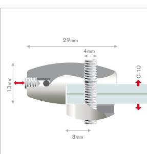
**T** pinza laterale regolabile. per pannelli su cavi di acciaio. il fissaggio di pannello e di cavo avviene tramite le brugole. spessore del cavo: max. Ø1,8mm.
