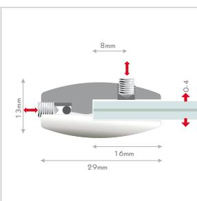
**T** pinza laterale per pannelli su cavi di acciaio. il fissaggio di pannello e di cavo avviene tramite le brugole. fissaggio: pinza laterale per cavi di acciaio, sistema a brugola. spessore del pannello: max. 4mm. spessore del cavo: max. Ø1,8mm.
