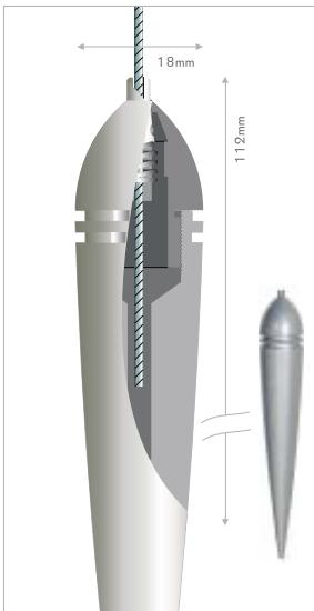
**I** contrappeso per sistemi su cavi con autobloccaggio. tiene il cavo in tensione senza montaggio: inserire il cavo nel sistema autobloccante, che lo trattiene automaticamente. peso: 110g. spessore del cavo: max. Ø1,8mm.
