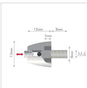
**I** fissaggio laterale per pannelli, sistema a brugola. supporto laterale per pannelli su cavi di acciaio. avvitare il morsetto nel pannello. il fissaggio al cavo di acciaio avviene tramite la brugola. spessore del pannello: almeno 6mm, filetto M4. spessore del cavo: max. Ø1,8mm.
