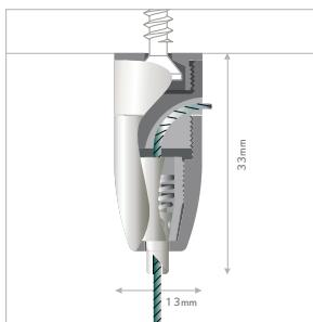
**IT** tirante per cavi con sistema autobloccante. fissaggio a soffitto per cavi di acciaio. montare il tirante a soffitto, inserire il cavo nel morsetto e regolare la tensione e la lunghezza del cavo grazie al forellino laterale. il meccanismo di autobloccaggio trattiene il cavo. spessore del cavo: max. Ø1,8mm.
