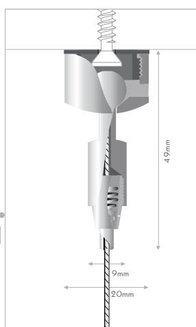
**IT** tirante snodabile per cavi, sistema autobloccante. fissaggio a soffitto universale per cavi di acciaio o nylon. montare il tirante a soffitto e inserire il cavo nel morsetto. il meccanismo di autobloccaggio trattiene automaticamente il cavo max. Ø1,2mm.
