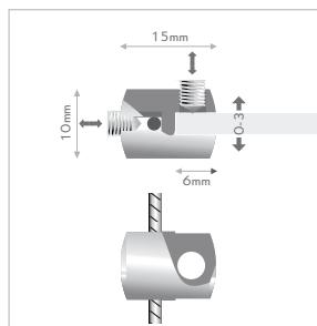
**IT** pinza laterale. per pannelli su cavi di acciaio. il fissaggio di pannello e di cavo avviene tramite le brugole. fissaggio: pinza laterale per cavi di acciaio, sistema a brugola. spessore del cavo: max. Ø1,2mm.
