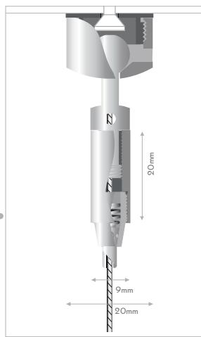
**IT** tirante snodabile per cavi, sistema variabile. montare il tirante ed inserire il cavo: il sistema di autobloccaggio lo trattiene automaticamente. la tensione del cavo si regola avvitando la parte snodabile del tirante. spessore del cavo: max. Ø1,2mm.
