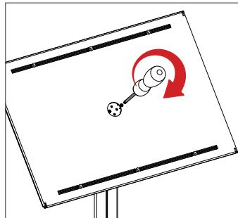
per il cambio da orizzontale a verticale (o viceversa) allentare le viti e fissarle di nuovo dopo aver modificato l'orientamento.
